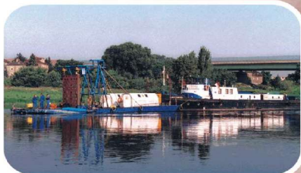
Tauchen in starker Strömung mit Strömungsschutzschild Darstellung einer Pontoneinheit mit Strömungsschutzschild
