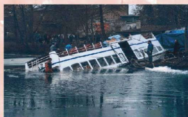
Hebesäcke zum Bergen (bis zu 100t)
