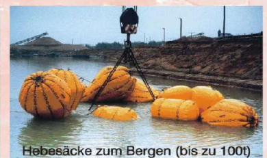
Hebesäcke zum Bergen (bis zu 100t)
