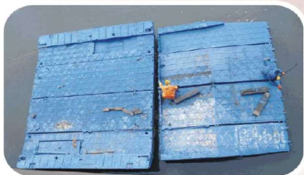
Koppelbare Pontoneinheit - aus Fluss- und Uferpontons (Uferpontons: bis zu 18 t Traglast; Flusspontons: bis zu 20 t Traglast)
